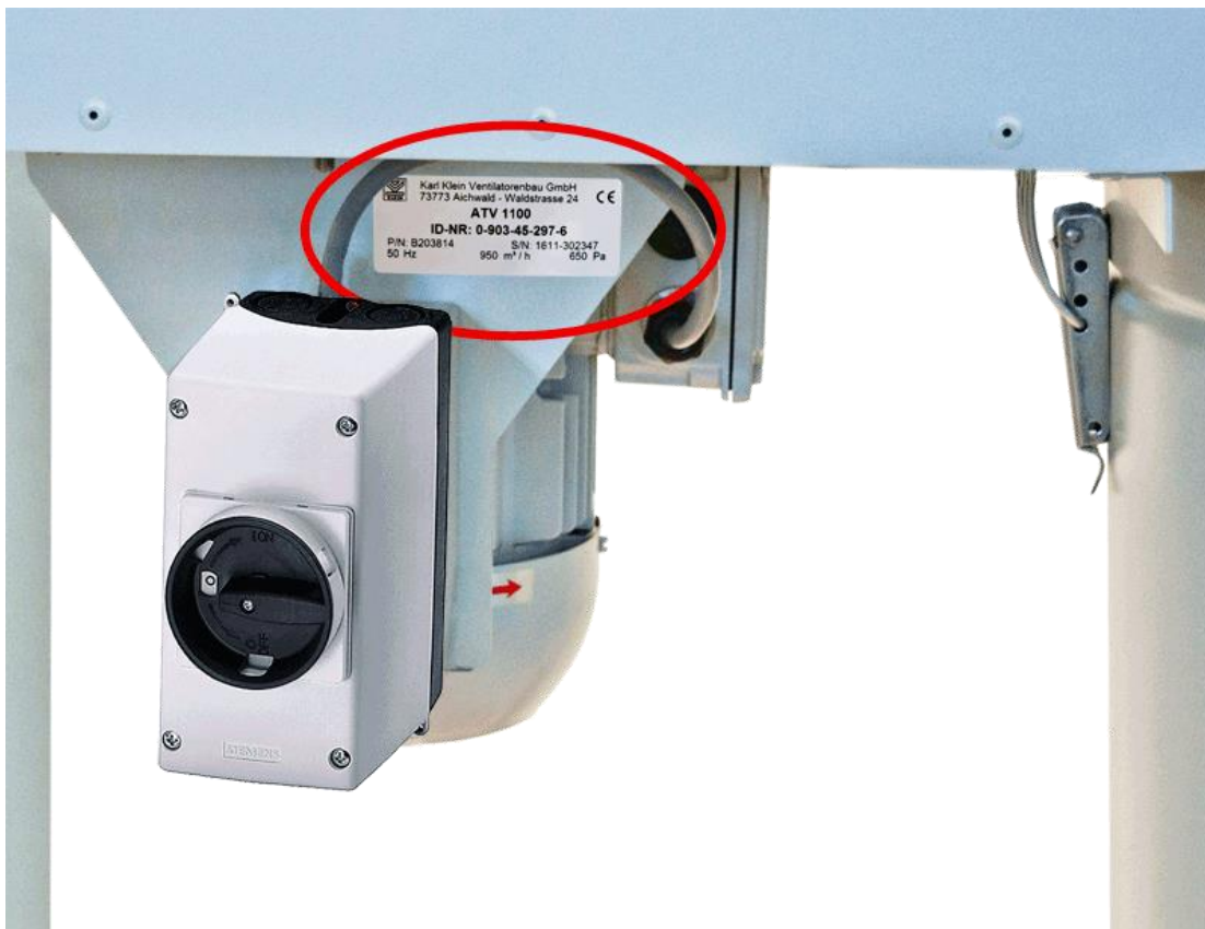
Bild 1.6.1: Typenschild für das Absauggerät
