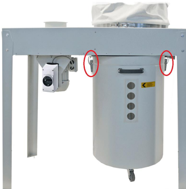
Bild 5.3.4: Staubsammelbehälter mit Spannhebeln am Traggestell festziehen
