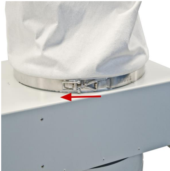
Bild 5.3.2 Filtersack über Stützen ziehen und mit dem Spannband festziehen
