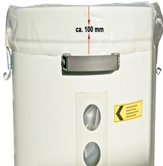
Bild 5.3.3: Staubbeutel in Staubsammelbehälter einlegen
