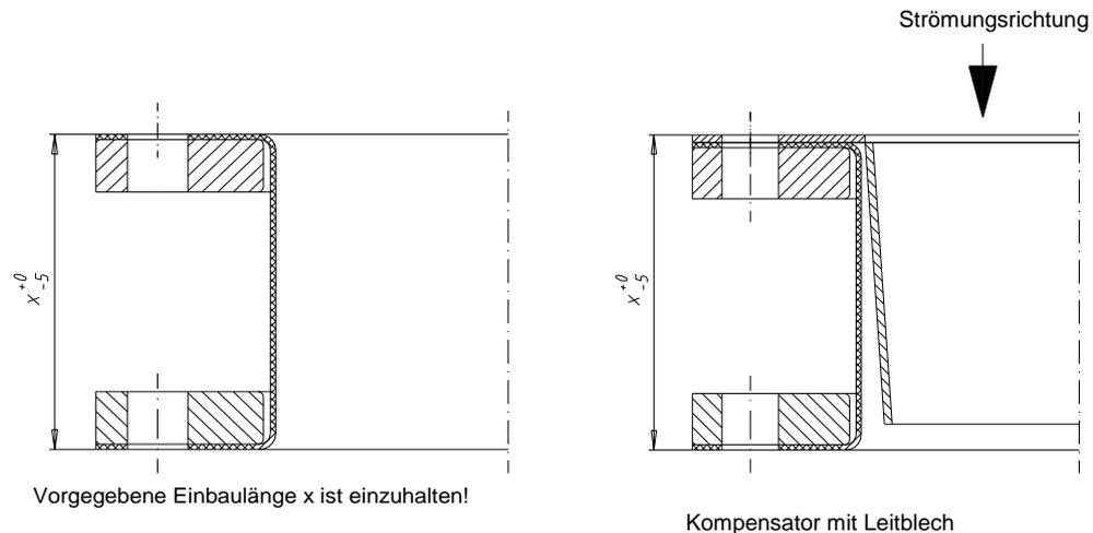
Kompensatoren mit einem Leitblech können nur ganz geringe laterale und axiale Bewegungen aufnehmen. Angularbewegungen dürfen nicht auftreten, da sonst das Leitblech den Kompensatorbalg beschädigen kann. Ein Leitblech ist zum Schutz des Kompensators gegen Abrieb und aus strömungstechnischen Gründen eingebaut.
