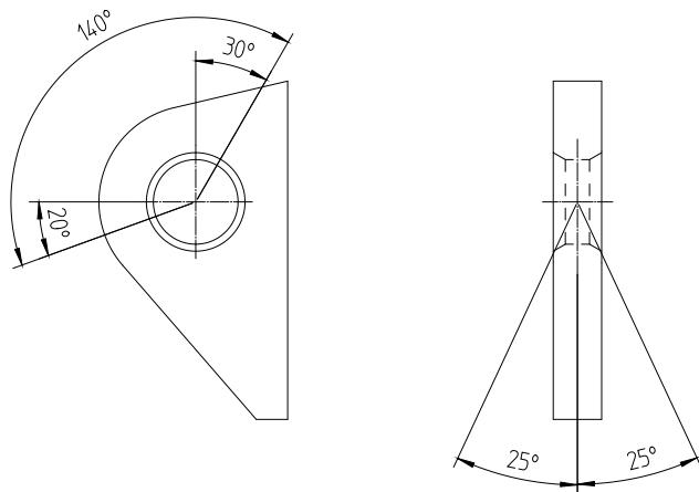
přípustné směry zatížení
