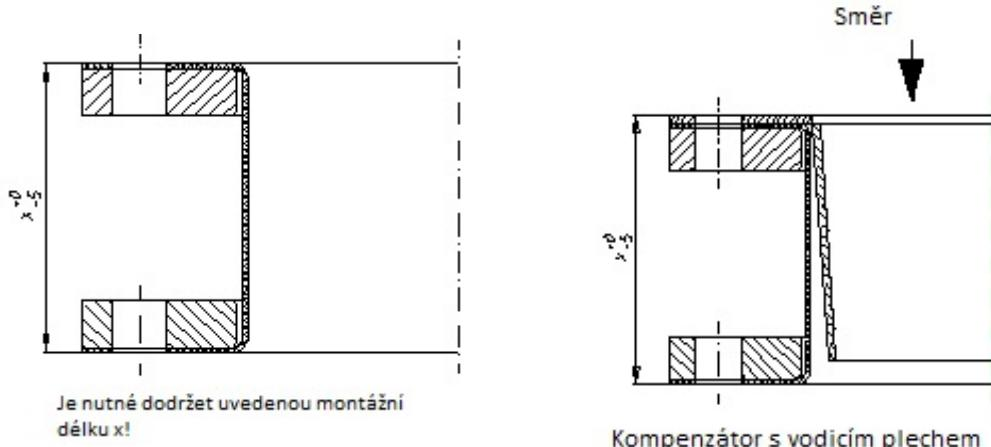
Kompenzátory s vodicím plechem mohou zachycovat pouze zcela nepatrné boční a axiální pohyby. Úhlové pohyby se nesmí vyskytovat, protože jinak by vodicí plech mohl poškodit kompenzátor. Vodicí plech je nainstalován za účelem ochrany kompenzátoru proti odřu a z aerodynamických důvodů.
