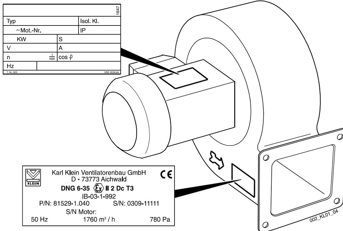
Las indicaciones en las placas de características caracterizan el tipo de ventilador deseado y su potencia.
