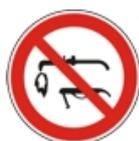
Interdiction d'effectuer des travaux de soudure à l'arc sur le ventilateur
