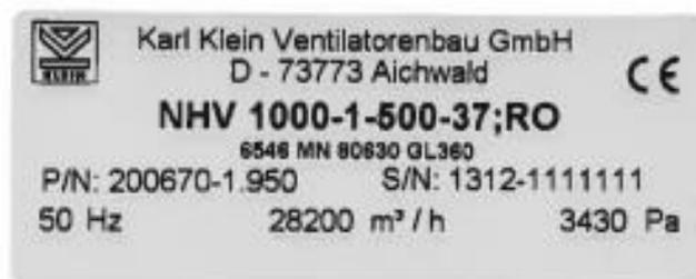
Le numéro de la machine figure sur la plaque signalétique du ventilateur.
