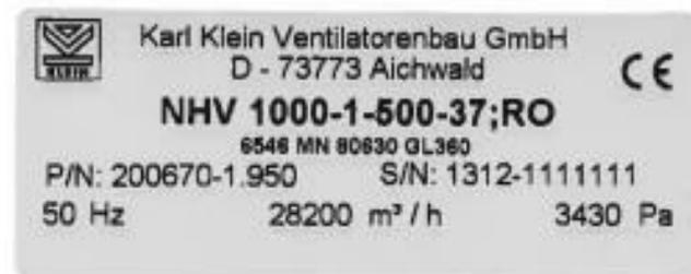
Le numéro de la machine figure sur la plaque de type du ventilateur.
