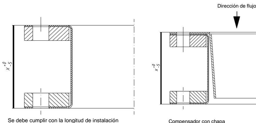
Los compensadores con chapa directriz pueden absorber movimientos laterales y axiales muy pequeños. No pueden ocurrir movimientos angulares ya que la chapa directriz podría dañar el fuelle compensador. La chapa directriz se monta para proteger el compensador contra el desgaste y por motivos técnicos de flujo.
